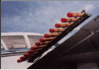
Uçak kanadına takılmış bulut tohumlama fişekleri
