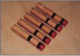
50 gr gümüş iyodür içeren bulut tohumlama fişekleri
